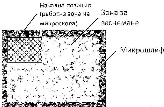
Фиг.2. Начална позиция на заснемане на микрошлифа
